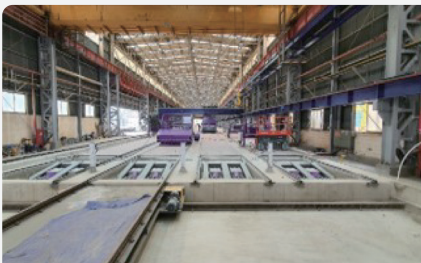
슬라브 제작장 / 130m 3 (일) Casting Bed – 400Ton / 180m x 4Line
