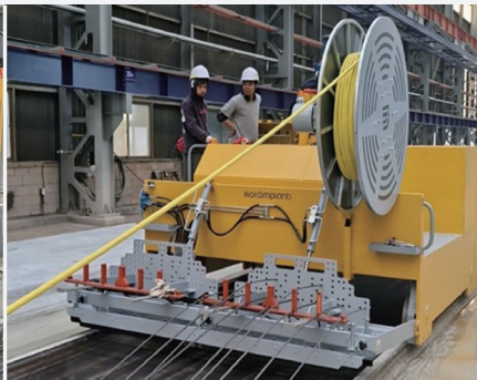
Bed master 베드 준비, 강연선 설치 설비
