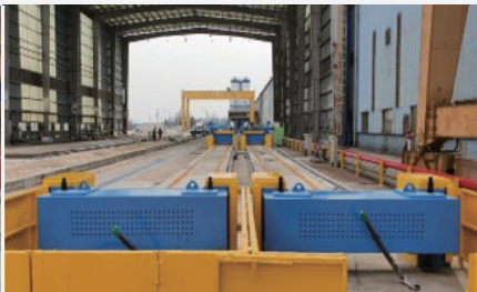
기둥, 보 제작장 / 170m 3 (일) 인 장 – 700Ton / 80m x 1Line 인 장 – 500Ton / 80m x 4Line 비인장 – 80m x 2Line
