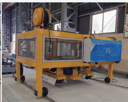
Grooving machine 슬라브 상부 거친면 처리 설비
